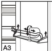
Положение полок, Рис. A4, можно регулировать в соответствии с высотой замороженных продуктов. Для того чтобы сделать это, приподнимите полку, вытяните ее наполовину и переместите вниз (или вверх).
