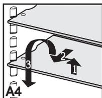
Рис. A5. Если вам необходимо пространство для больших бутылок и емкостей, втолкните половину стеклянной полки ① назад. При чистке можно использовать держатель ② для снятия половинок стеклянных полок.
