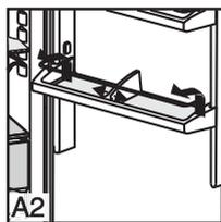
Нажав на **держатель для бутылок**, как показано на Рис. A2/A3, вы можете защитить бутылки от опрокидывания при открывании и закрывании двери. Держатель можно снять для чистки:
